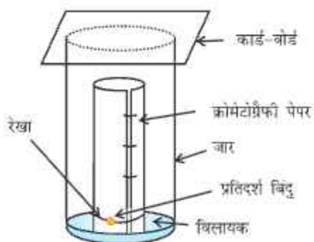
चित्र 12.13 कागज क्रोमेटोग्राफी। दो भिन्न आकृतियों का क्रोमेटोग्राफी पेपर।
