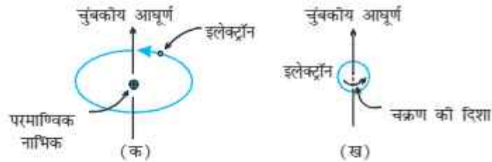
चित्र 1.35—(क) इलेक्ट्रॉन की कक्षीय गति, (ख) इलेक्ट्रॉन की चक्रण गति के साथ संयुक्त चुंबकीय आघूर्ण का निदर्शन
