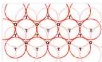
चित्र 1.20 – निविड संकुलित गोलों की दो परतों का एक स्तंभ और उनमें जनित होने वाली रिक्तियाँ T = चतुष्फलकीय रिक्ति O = अष्टफलकीय रिक्ति
